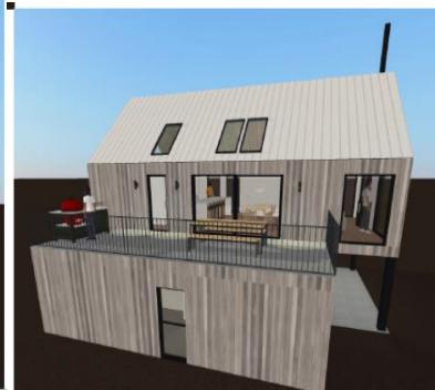
Toiture en acier grise et parement en cèdre pré-veilli
